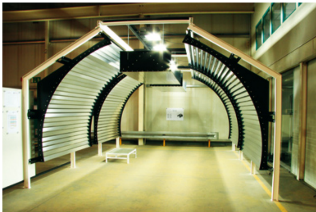
Der patentierte Inspektionstunnel erzeugt mittels Lichtsegeln und Reflektionstechnik ein gleichmäßiges Bild auf der Oberfläche, das den Mitarbeiter bei der Arbeit unterstützt. Quelle: LDV-Systeme
